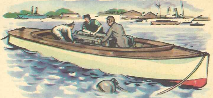
Under tiden överflyttade Austin sitt intresse även till stationära motorer och marinmotorer. Den här båten med två Austin V-12-motorer på vardera 380 hk gjorde över 50 knop och var sin tids snabbaste.
